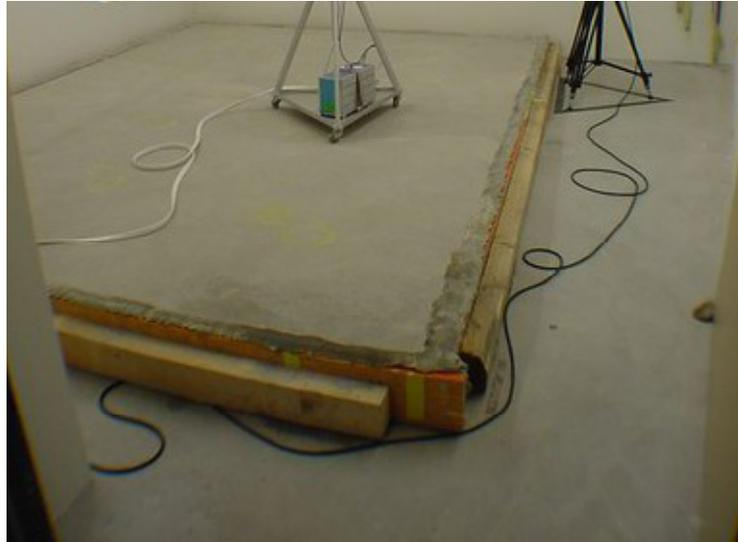
Abbildung 4: Randabschluss des schwimmenden Deckenaufbaus im oberen Raum (232c) (Foto: Empa)
