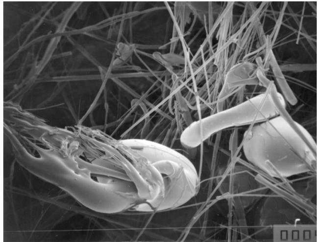
Darstellung 8 [43]: Rasterelektronenmikroskopaufnahme von Steinwolle
